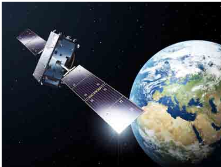
Satellite Galileo piazzato in orbita media, a 23 222 km di altitudine (foto ESA-P. Carril)
